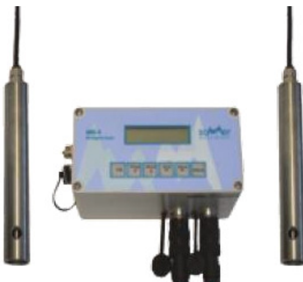
Abb. 10: Salztracer-Messgerät SOMMER MST-4 mit Leitfähigkeitsmesssondendublette (Herstellerfoto)
